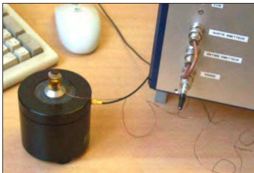
Fig. 10 : Le palpeur acoustique relié à son électronique d'acquisition.
