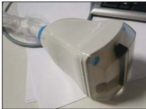
Figure 10: Sonde d'imagerie ultrasonore 3D permettant d'acquérir en un temps très court (quelques secondes) un volume d'élasticité ( 40 \text{ mm}^3 )
