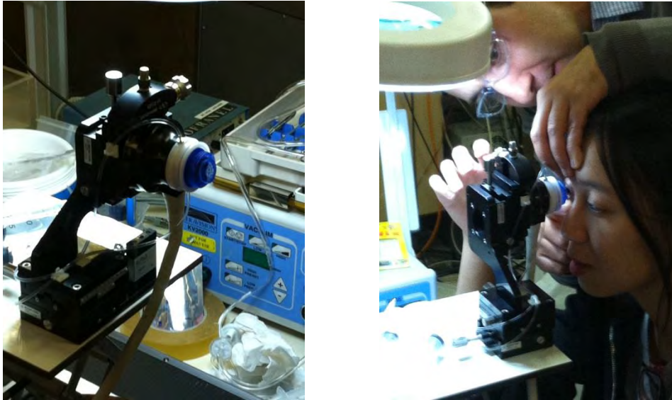
Figure 20. Système d'adaptation de la sonde échographique à l'œil humain. L'ensemble se monte sur une lampe à fente pour faciliter le travail de l'ophtalmologiste.
